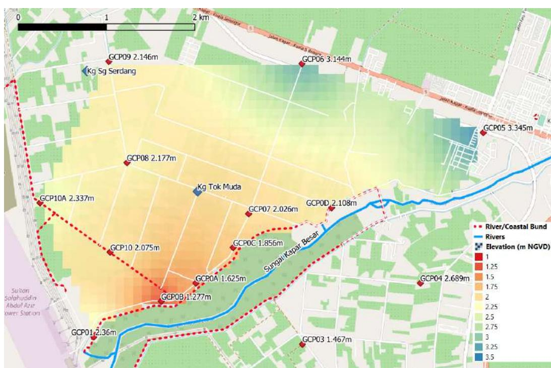
Rajah 65: Taburan titik ketinggian yang disurvei menggunakan DEM interpolasi IDW.
